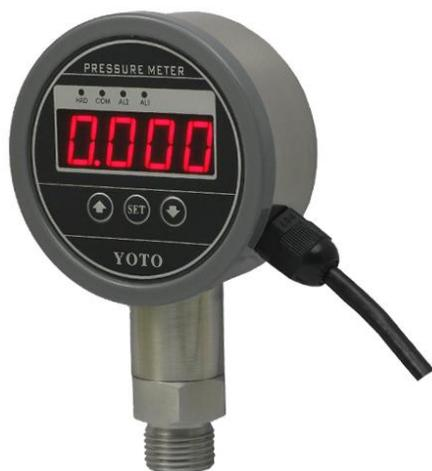
**1; 产品简介** PG801E 数显压力表是集压力测量、显示、控制于一体的多功能产品。仪表内部采用微机数据分析控制,运用先进的温度补偿技术,具有高精度、低漂移,反应灵敏等优点。采用全数字化现场显示,可根据用户需要输出 4-20mA、1-5V 等多种标准信号形式。
